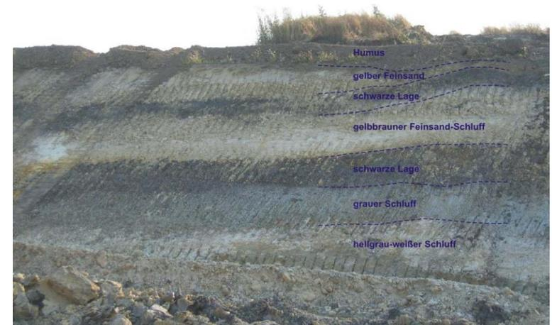
**Böschungprofil aus dem Raum Dürnbach. Die ausgeprägte Wechsellagerung ist charakteristisch für die terrigenen Ablagerungen des Pannonium. (Posch-Trötzmüller, 2007)**
