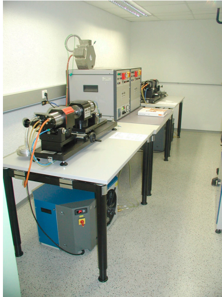
Bild 10: 4-Punkt-Umlaufbiegemaschinen mit Hochtemperaturofen (Fa Walter+Bai)
