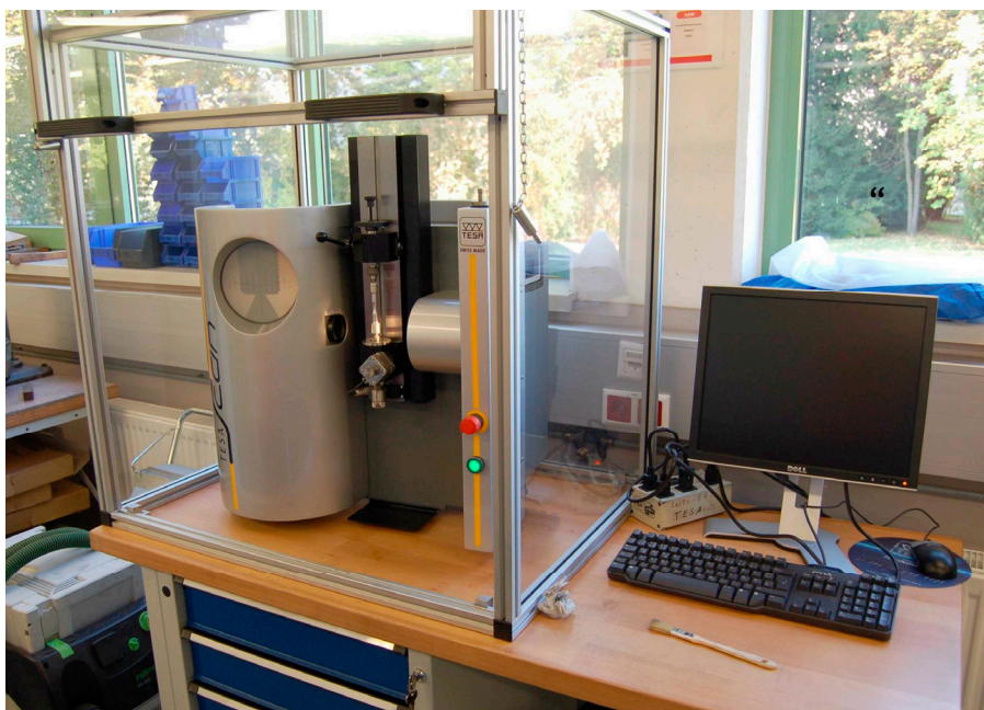
Bild 9: Lichtvermessungsgerät Tesa Scan 50 (Fa. Tesa)
