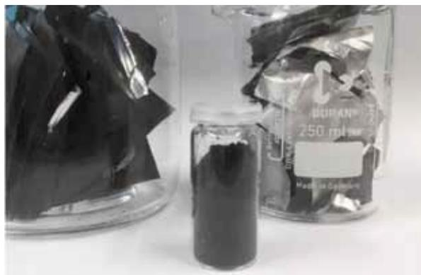
Elektroden aus einer ausgedienten Autobatterie, mitte: Elektrodenaktivmaterial nach der Trennung, rechts: Aluminiumstromableiter nach der Trennung. © KIT
