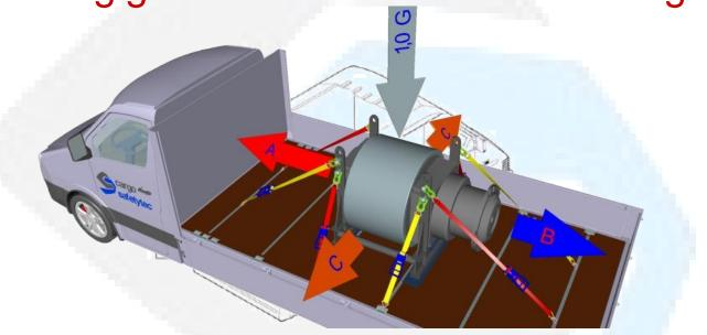
Für den üblichen Fahrbetrieb mindestens zu berücksichtigende Massenkräfte:
