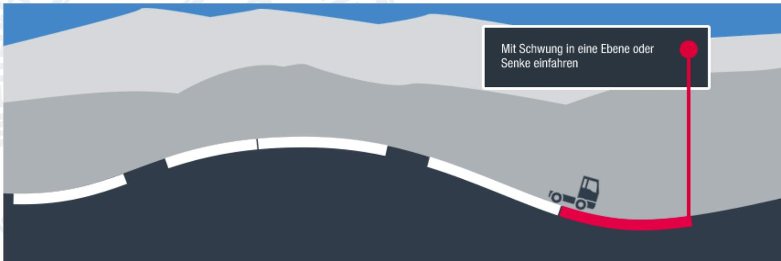
Vor Steigungen erhöht MAN EfficientCruise® die Geschwindigkeit um bis zu 2 km/h. Das „Schwungholen“ führt zu einer besseren Bewältigung von Steigungen und kann damit sonst notwendige Rückschaltungen vermeiden.
