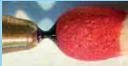
Zwischen einer 1mm-Stahlkugel und dem Tropfen Testflüssigkeit, der zum Größenvergleich auf einem Zündholzkopf aufgebracht wurde, bildet sich ein typischer Meniskus aus. (Quelle: IMA GmbH)
