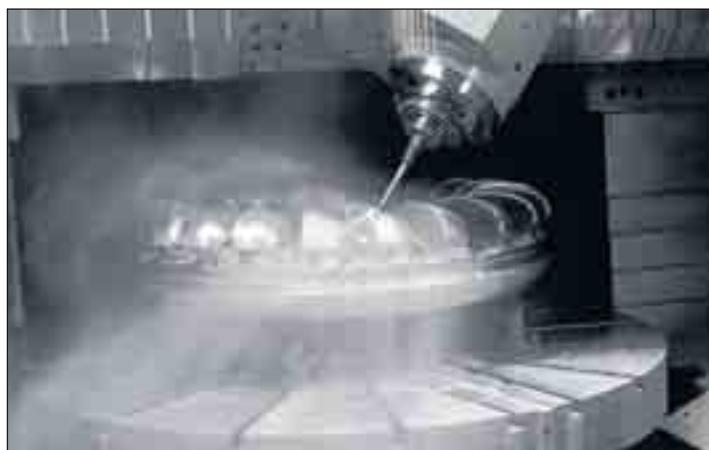
Das neue Fünf-Achsen-CNC-Bearbeitungszentrum bei der Fertigung eines Peltonturbinen-Laufrades.
