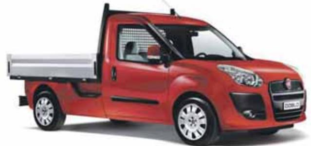
drei Turbodiesel-Triebwerke mit Multijet II-Technologie zur Wahl. Das Leistungsspektrum reicht von 90 PS bei einem Hubraum von 1,3 Litern über einen 1,6-Liter-Vierzylinder mit 77 kW (105 PS) bis zum Topmotor 2.0 Multijet II mit 135 PS, der serienmäßig die Emissionsnorm Euro 5 erfüllt.
