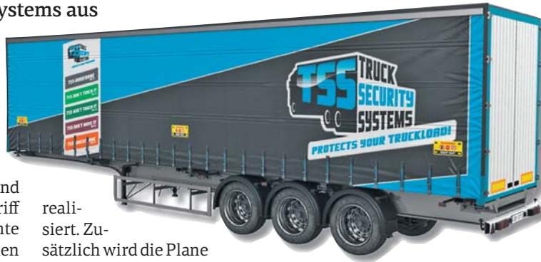
realisiert. Zusätzlich wird die Plane laufend durch zwei berührungslose Überwachungssysteme gesichert. Auch die Einsteckklatten sind mit entsprechender Sensorik ausgestattet und sorgen für eine Alarmierung bei unbefugtem Zugriff. Letztlich ist der gesamte
