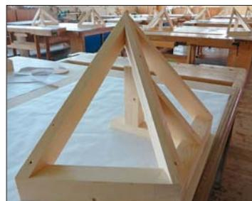
Fotos von links: Volle Konzentration beim Bewerb, die Jury bei der Bewertung und das fertige Werkstück: Gratsparrn für ungleiche Dachneigung, aufgeklaut auf die Mauerbank mit einem Schifter und zwei Klauenschiftern.
