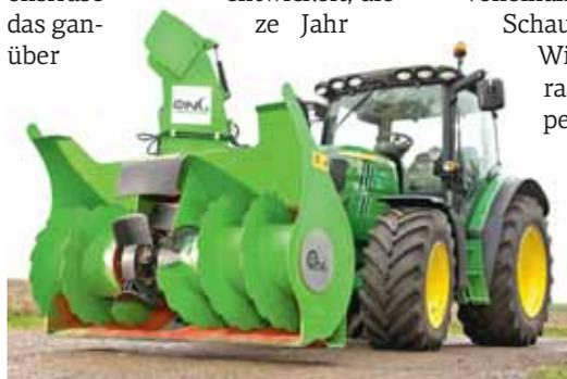
ne Krafteinwirkung. Herkömmliche Schneefräsen benötigen im Schnitt über 1.000 Umdrehungen pro Minute (UPM), der Fräsinator eco 2.5 bringt mit gerade einmal 250 UPM die gleiche Leistung. Durch dieses neuartige Antriebsverfahren kann somit bis zu 70% an Energie eingespart werden.
