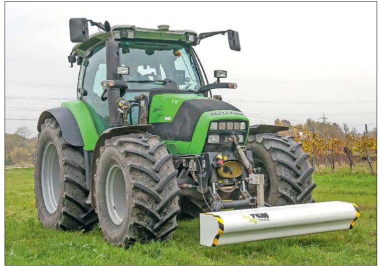
Vorne am Traktor montiert vermisst der „Topsoil Mapper“ den Boden.
