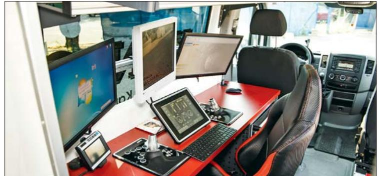
Ausstattung deluxe: Im Fahrzeug für die Kanalinspektion – bei Bedarf auch mit Kaffeemaschine – werden die gewonnenen Daten gesammelt und ausgewertet.
