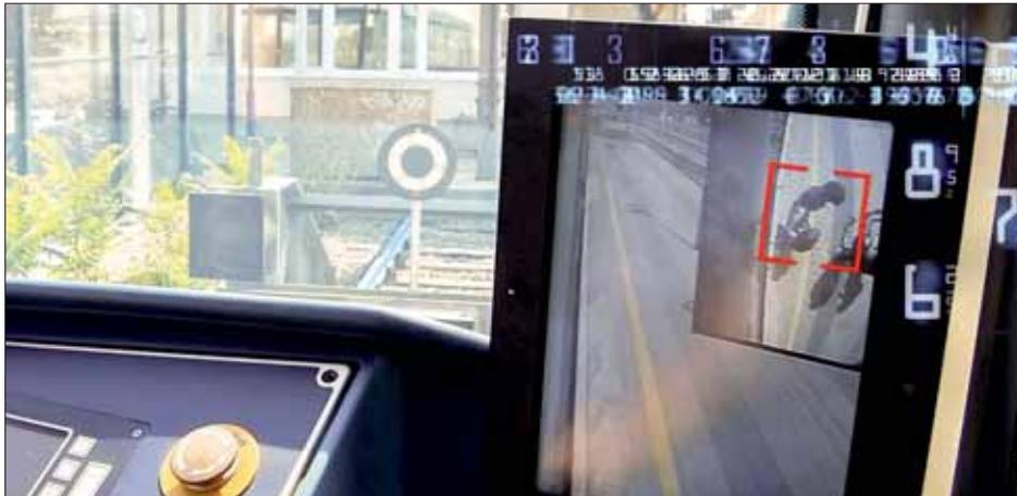
Eine Kamera, die den Rückspiegel ersetzt, sorgt für eine höhere Verkehrssicherheit.
