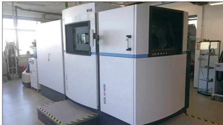
Dieses 3D-Druck Labor der Fotec mit einer neuen Anlage vom Typ EOS M400 können Sie am 18. Mai besichtigen. Foto: Fotec
