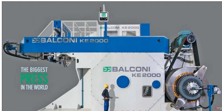
Mit einer weltweit einzigartigen Presskraft von 2.000 Tonnen punktet künftig der Neuman Aluminium-Standort in Markt mit seiner neuen Fließpresse.
