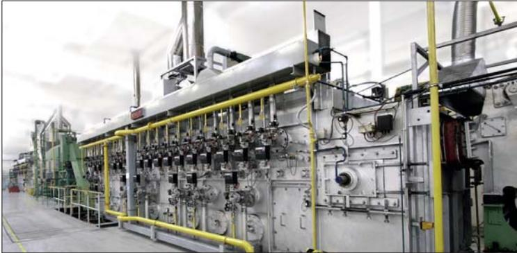
Dieser Gussgliederbandofen von 80 Meter Länge und 230 Tonnen wurde in Mödling gefertigt.
