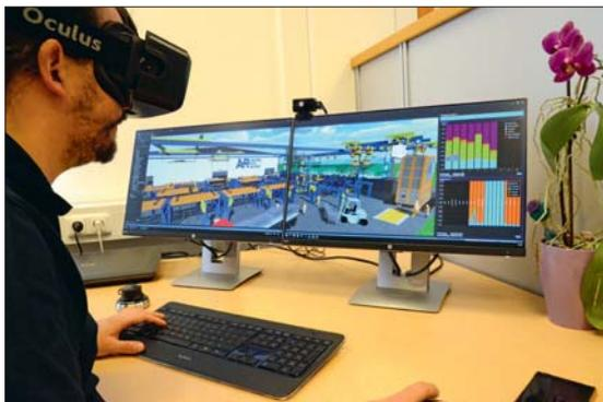
Funktion „Capture Replay“ ermöglicht auch ein Abrufen vergangener Produktionsabläufe auf Basis der geloggtten Daten. Sprich, mit dem gleichen Tool, mit dem die 3D-Simulation dargestellt wird,
