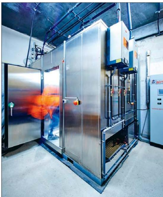
Mittels eines neuen Großprüfgerätes können bei Smart Minerals die echten Einwirkungen auf die Bauteile wie im Zeitraffer nachgestellt werden.
