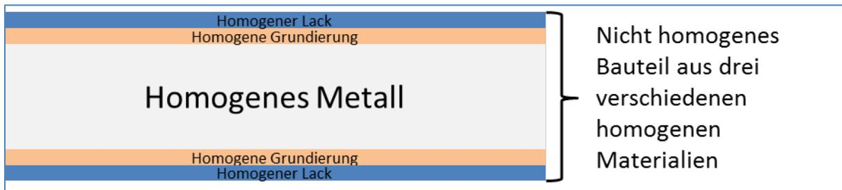
Abbildung 1: Homogene Schichten eines nicht homogenen Bauteils
