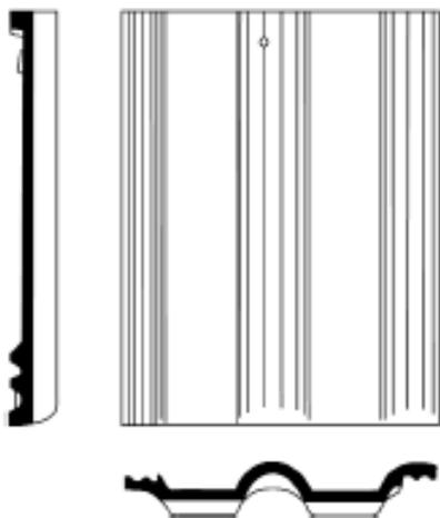
Abb. 1: Betondachstein, 10-er Format, symmetrisch
