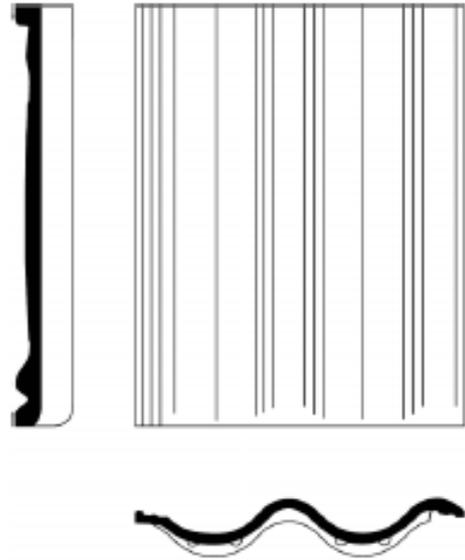
Abb. 4: Betondachstein, 7,5-er Format, symmetrisch
