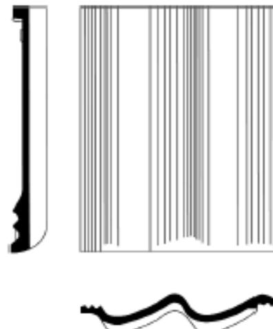
Abb. 2: Betondachstein, 10-er Format, asymmetrisch
