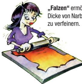
„Falzen“ ermöglicht es, die Dicke von Narben und Spalt zu verfeinern.
