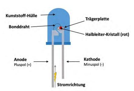
Aufbau einer Leuchtdiode. Zentrales Bauteil ist der Halbleiter-kristall, der bei Stromdurchfluss Photonen/Lichtteilchen abgibt.
