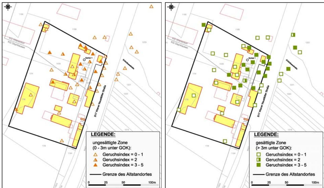
Abb.5: Verteilung der Untergrundkontamination (0 bis 3 m und > 3 m unter GOK) auf Basis des Geruchsindex
