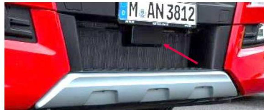
Radarsensor im Stoßfänger, Kamera hinter der Frontscheibe
