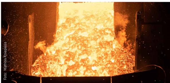
**Elektrolichtbogenofen im Stahlwerk Marienhütte während der Feinungsphase: Thermische Prozesse bieten fast in jeder Industrie Potenzial zur Lastverschiebung. Zugleich müssen spezifische – und oft komplexe – Randbedingungen eingehalten werden, um die Produktqualität sicherzustellen.**
