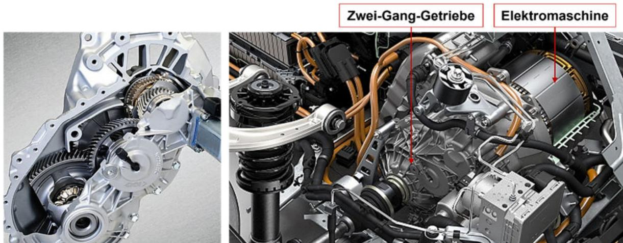
Abbildung 2-41: Aufbau des schaltbaren Zweiganggetriebes der elektrischen Antriebsachse des BMW i8 [6] [65]
