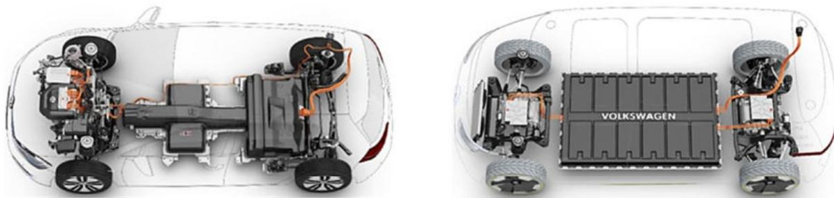
Abbildung 1-7: (a) Conversion Design links: VW e-Golf und (b) Purpose Design rechts: VW MEB-Plattform [9]
