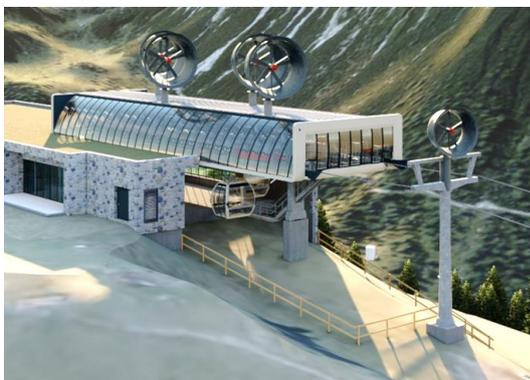
Eine größere Turbine (16kW) für einen Einsatz auf der Station, sowie eine kleinere Turbine (10kW) für den Einsatz auf der Stütze.
