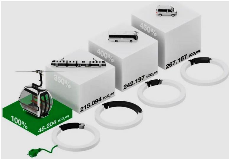
c. Treibhausgase in den Produktphasen (Ökobilanz Seilbahn „Línea Roja“)<sup>70</sup>
