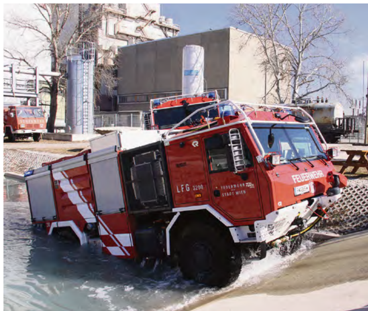
Für die von Tschann gelieferten Waldbrand-Löschfahrzeuge sind auch Bach- und Flussbetten kein Hindernis. Die sogenannte Watfähigkeit beträgt 1.200 Millimeter.
