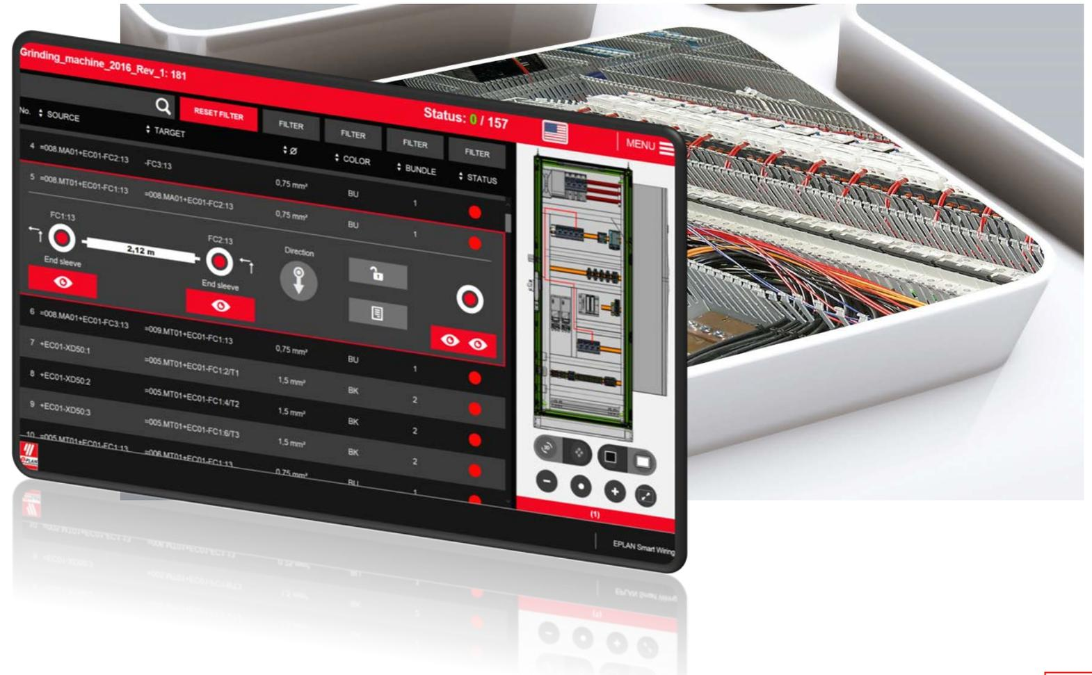
Mit SMART Wiring können digitale Fertigungsdaten, für die Verdrahtung, inkl. Schritt für Schritt Anweisungen für den Elektrotechniker bereitgestellt werden.
