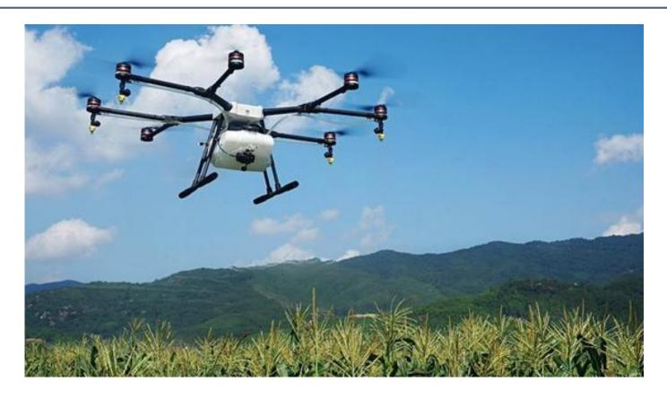
Agras MG-1: Die **Drohne** des chinesischen Hersteller DJI ist die weltweit erste, die Äcker mit Flüssigdünger, Pestiziden und Fungiziden versorgen kann. Fährt Agrarhändler dann noch mit dem Lkw zum Bauer?
