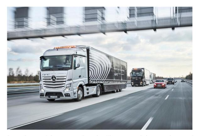
Platooning - das Kolonnenfahren von Lkw, die über eine elektronische Deichsel miteinander verbunden sind; Studie der ACEA ergibt: bis zu 16 Prozent weniger Spritverbrauch beim Platooning. Foto: Daimler
