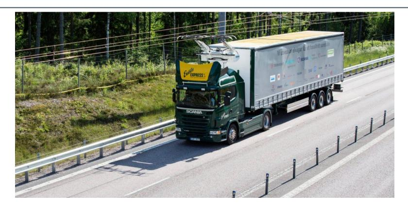
Am 22. Juni 2016 ging in <u>Schweden</u> der erste eHighway auf einer öffentlichen Straße in Betrieb. Auf einem zwei Kilometer langen Autobahnabschnitt der E16 nördlich von <u>Stockholm</u> wird für die nächsten zwei Jahre das <u>Siemens</u>-Oberleitungssystem für Lkw getestet. Foto: Scania CV AB
